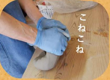
土を練っていきます。練ることで、粘土の固さをなくし、空気を抜くことができます。
